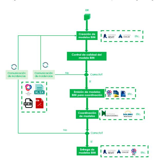
Figura 1. Flujo de coordinación y control de calidad de los modelos BIM.
